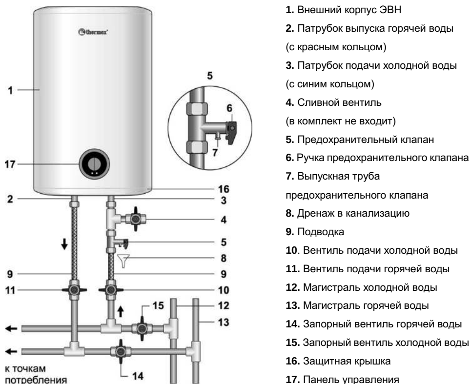
Рисунок 2. Схема подключения ЭВН к водопроводу
